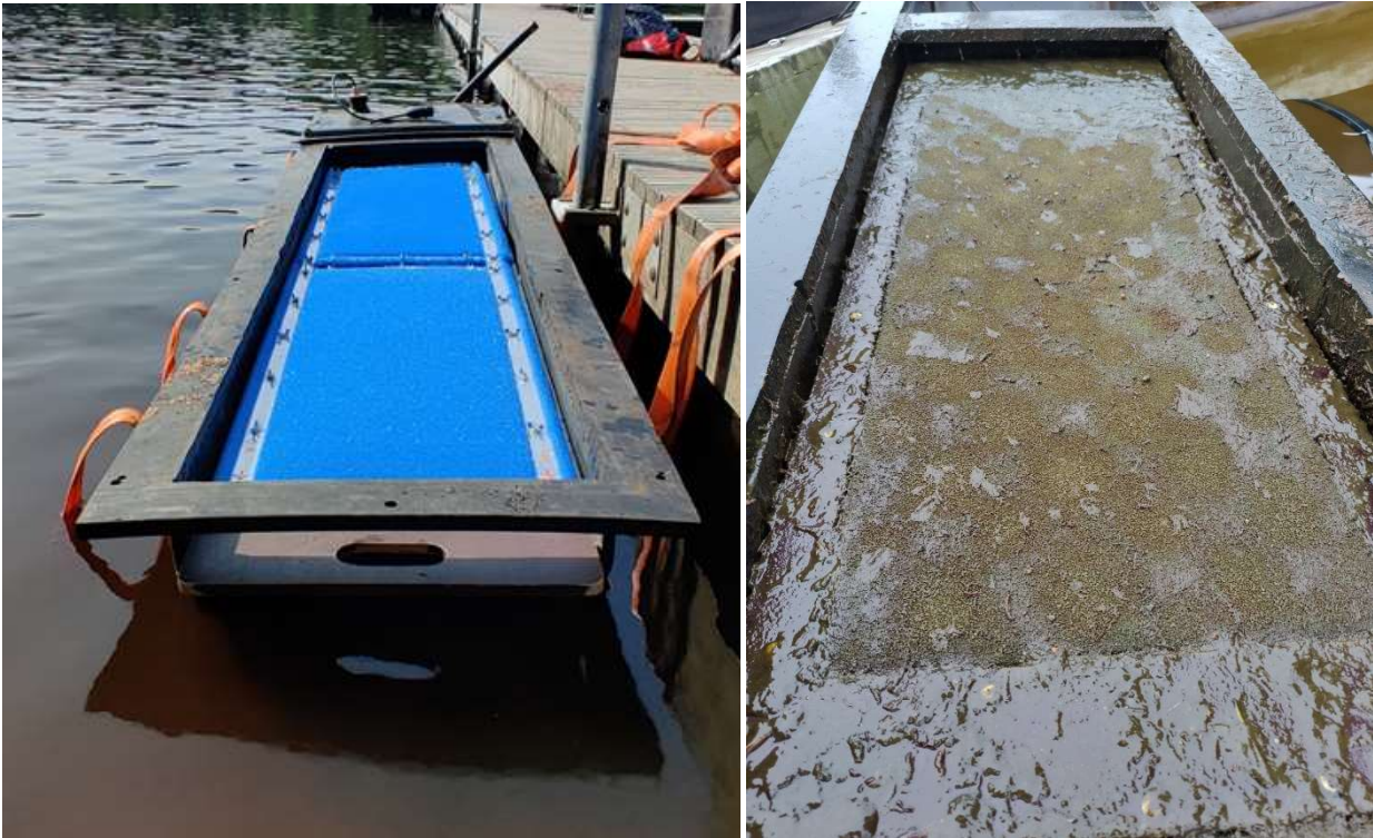
Kuva 2 ja 3: Biosuodattimen yläpuolinen esisuodatin ennen asentamista ja kauden jälkeen.
