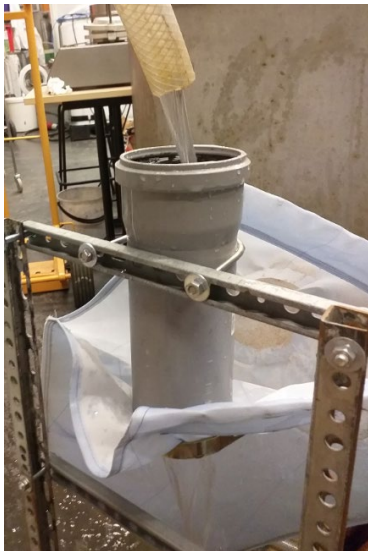
Kuva 3. Tyhjän suodattimen virtauskapasiteetin mittaaminen
